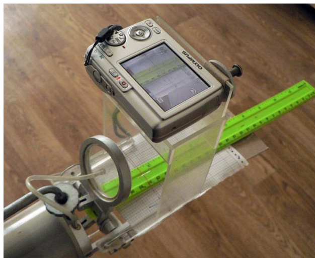
Рис. 2 Приспособление для измерения площади теневой проекции
