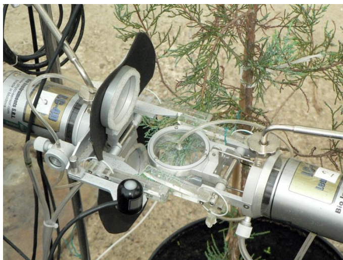
Рис. 1 Измерительные камеры монитора фотосинтеза РТМ-48А
