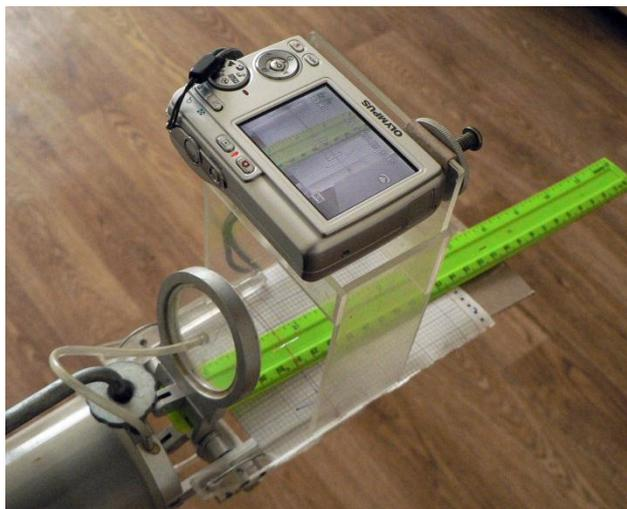
Рис. 2 Приспособление для измерения площади теневой проекции
