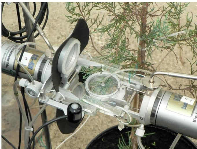
Рис. 1 Измерительные камеры монитора фотосинтеза РТМ-48А
